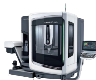
DMG MORI DMU80evo liner 加工エリアX/Y/Z: 800/650/550 主軸回転数: 24,000rpm 工具本数: 120本 センタスルー吐出量: 8MPa 【特長】 X/Y軸リニアドライブ
