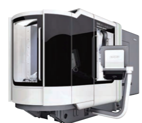
DMG MORI DMC60U duoBLOCK 加工エリアX/Y/Z: 600/700/600 主軸回転数: 24,000rpm 工具本数: 123本 センタスルー吐出量: 8MPa 【特長】 2パレットチェンジャー
