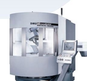
DMG MORI DMU60 monoBLOCK 加工エリアX/Y/Z: 730/560/560 主軸回転数: 18,000rpm 工具本数: 60本 センタスルー吐出量: 4MPa
