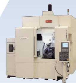
安田工業 YBM Vi40 加工エリアX/Y/Z: 900/500/450 主軸回転数: 24,000rpm 工具本数: 60本 センタスルー吐出量: 6MPa 【特長】 X/Y/Z/B/C軸光学スケールフィードバック 機体温度制御装置
