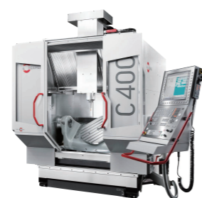
HERMLE C400 加工エリアX/Y/Z: 850/700/500 主軸回転数: 18,000rpm 工具本数: 81本 センタスルー吐出量: 4MPa 【特長】 0.0001mmフルスケールフィードバック 人造石一体フレーム
